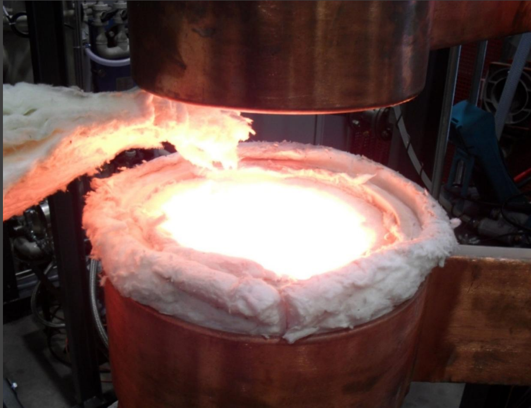
ASMET 2016 - Induktive Erwärmung einer Graphitschüttung
